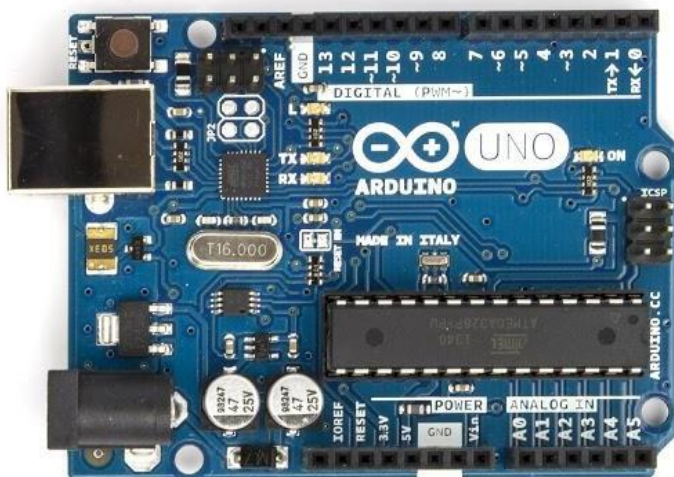
Picture 2.3. Arduino Uno (Source : Prawoto, 2015)
